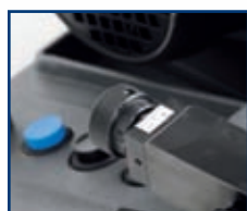
2 Índice copiadur con regulación micrométrica.
